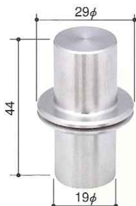
KB-3410 品名/20φ用回転軸 材質/ステンレス
