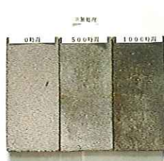
無処理 モルタル体
